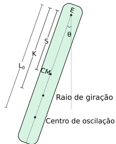
onde  $\phi$  indica o ângulo formado entre a reta que passa pelo eixo e o centro de massa e a direção vertical. A aplicação da segunda lei de Newton a movimentos de rotação leva a:
