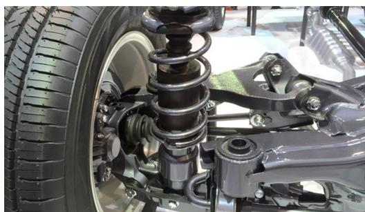
Figura 1.7: Sistema de amortecimento de um carro.
