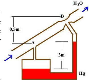
21. No manômetro da figura, o fluido A é água e o B, mercúrio. Qual é a pressão  $p_1$  ?
