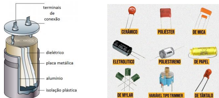
Figura 2: Capacitor eletrolítico por dentro (esquerda). Tipos de capacitores (direita).
