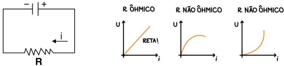
Figura 1: Circuito com uma fonte de tensão e resistor. Gráfico ilustrando a relação tensão( U ) x Corrente ( I ) para um resistor ôhmico e resistores não ôhmicos. Clique na figura para ver a simulação
