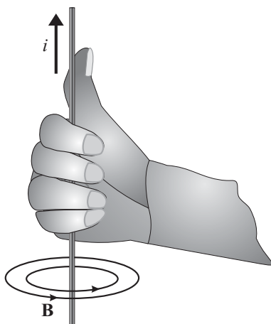
Figura 2: Regra da mão direita aplicada a um fio por onde passa uma corrente elétrica i .
